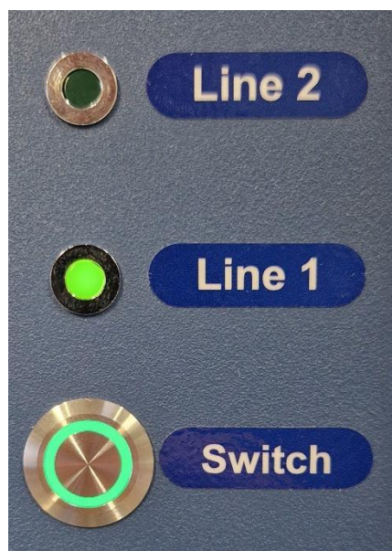
Joonis 20.2. Mitmekambrilise kehavälise viljastamise inkubaatori MIRI® TL12 liini muutmise lüliti ja aktiivne liin 1
