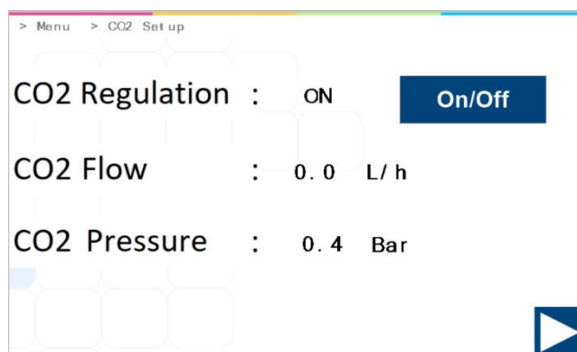
Joonis 13.25. Mitmekambrilise kehavälise viljastamise inkubaatori MIRI® TL6 ja MIRI® TL12 CO 2 seadistuse alammenüü vaade
