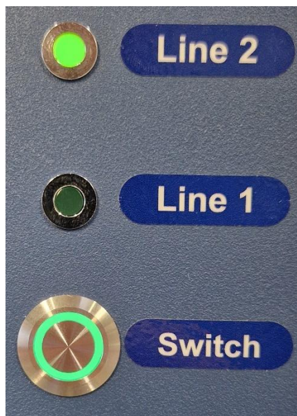
Joonis 20.4. Mitmekambrilise kehavälise viljastamise inkubaatori MIRI® TL12 liini muutmise lüliti ja aktiivne liin 1
