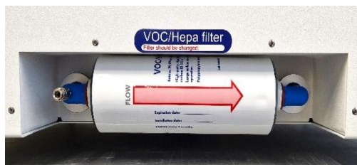
Joonis 12.3. Õigesti paigaldatud VOC/HEPA filter
