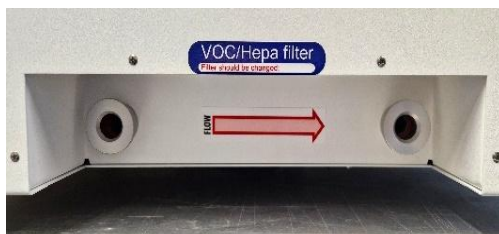
Joonis 12.1. Voolunool mitmekambrilistel kehavälise viljastamise inkubaatoril MIRI® TL6 ja MIRI® TL12
